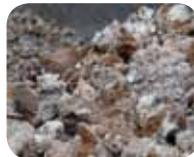
Die größte Problemstellung im Recycling der deponierten Materialien stellt sich jedoch im Brechverhalten der Schlacke selbst, da sie unbrechbare Materialien enthalten (Eisen, Stahl....), die bei herkömmlichen Brechanlagen Blockaden der Brechkammer und häufig auch schwerere Schäden verursachen.
